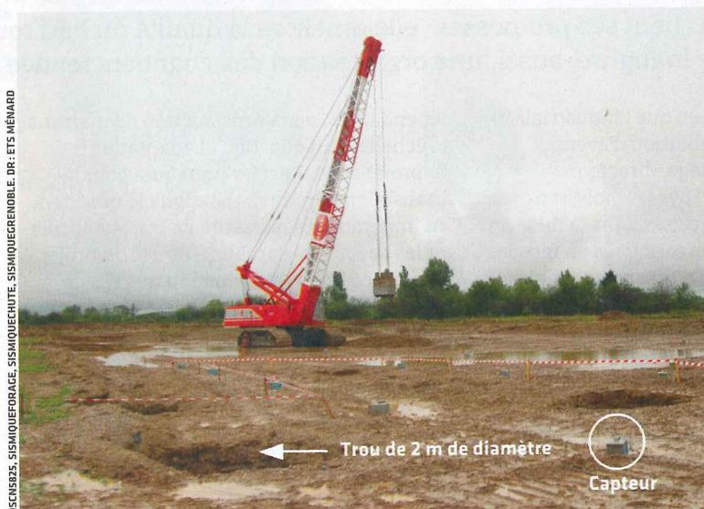
Faire chuter de 20 m, une dizaine de fois, une masse de 17 tonnes suspendue à une grue pour créer des microséismes de 12 hertz (niveau 4 sur l'échelle de Richter). Puis observer le comportement des ondes traversant un sol percé d'une vingtaine de trous verticaux de 3 m de diamètre et 5 m de profondeur. L'expérimentation conduite en septembre 2012 par Ménard, à Lyon, prouve que ce dispositif détourne les ondes.
