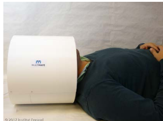
Figure 1 : antenne émettrice pour IRM ultra haut champ (7 Tesla) pour la tête ; brevet copropriété du CNRS, d'Aix-Marseille Université, de l'Ecole Centrale Marseille et du Commissariat à l'Energie Atomique. Crédits photographiques : © 2017 Institut Fresnel. HD sur demande.
