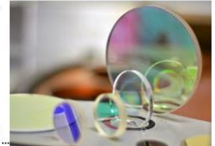
Figures : Gauche - Performances spectrales en transmission mesurées et théoriques du filtre fabriqué Droite - Illustration des filtres optiques interférentiels
