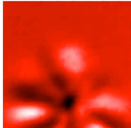
Figure 8: Absorption à 244 nm. Cartographie autour de l'endommagement mono-tir de la figure 4 (Echantillon B, même échelle que figure 4).
