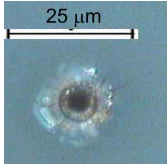
Figure 4: Microscopie : Echantillon B (Endommagement mono-tir, substrat en Herasil avec couche de silice, face avant).
