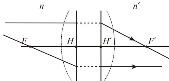
PPI: donné par l'intersection d'un rayon incident // à l'axe et du rayon émergent correspondant.
