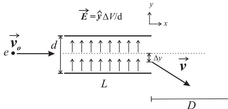
FIGURE 2 – Déviation d'un électron par un champ électrostatique
