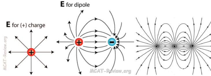
FIGURE 5 – Champ et équipotentielles d'une charge, d'un dipôle et d'un quadrupôle électrique.
