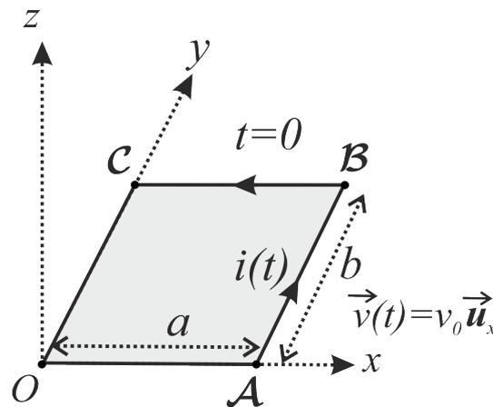
FIGURE 4 – Un circuit rectangulaire de dimensions  $a$  selon  $x$  et  $b$  selon  $y$  se déplace à vitesse constante,  $v_0$ , dans un champ magnétique statique mais non uniforme. Un courant,  $i(t)$ , est induit dans le cadre par induction magnétique.
