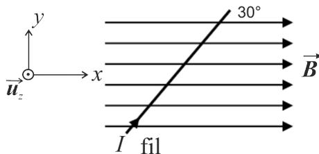
FIGURE 2 – Fil droit, de courant  $I$  à un angle de  $\theta = \pi/6 = 30^\circ$  d'un champ magnétique.
