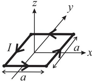
Considérons un circuit électrique de forme carrée, de côté  $a$ , situé dans le plan  $xOy$ . Un courant constant  $I$  circule dans ce circuit.
