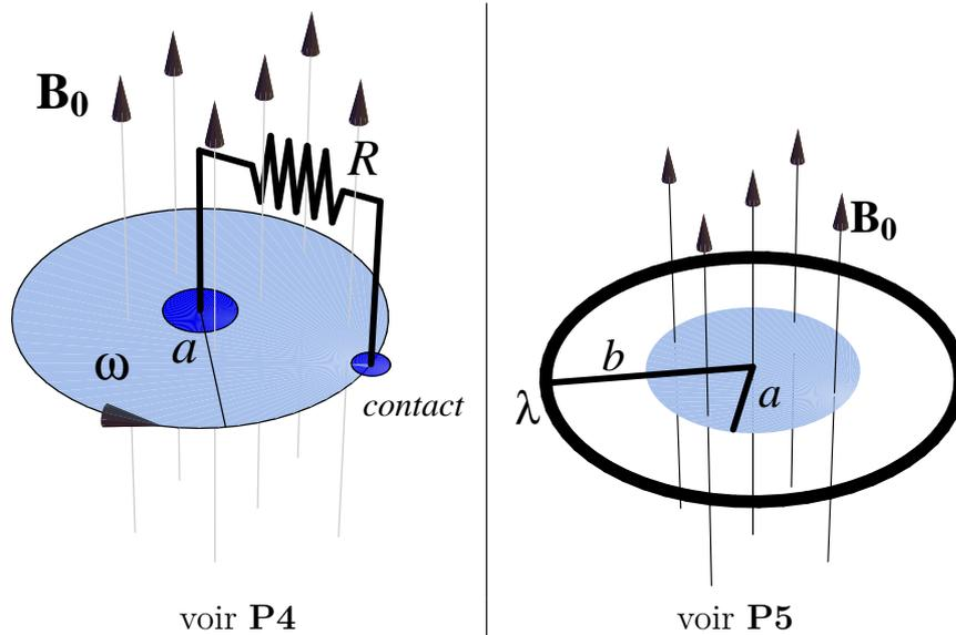
**P4.** (3 points) Un disque métallique de rayon  $a$  tourne à une fréquence angulaire constante  $\omega$ , dans un champ magnétique uniforme dirigé selon la direction  $z$ , perpendiculaire au plan du disque  $(x, y)$ . Un circuit extérieur de résistance  $R$  relie le centre et la périphérie du disque. Montrez qu'un courant est induit, et que sa valeur est  $I = \omega B_0 a^2 / 2R$ , où  $B_0$  est l'intensité du champ magnétique.
