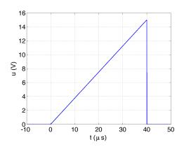
et la tension u(M,t) atteint la valeur 7,5 V au point M plus loin sur la ligne, à une distance de 15 km de S, à la date  $t_1 = 65 \,\mu\text{s}$ .
