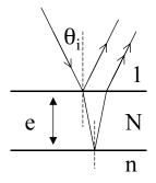
En vue de constituer une couche anti-reflets pour la radiation moyenne dans le visible ( $\lambda_0 = 550nm$ ), on dépose sur des verres de lunettes d'indice n = 1,7 une lame mince d'épaisseur uniforme e et d'indice N compris entre 1 et n. Seules interfèrent l'onde refléchie par le dioptre air-couche et celle refléchie par le dioptre couche-verre.
