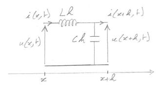
d'inductance Lh et de capacité Ch. Les tension et intensité sont u(x,t) et i(x,t) en entrée du cricuit et u(x+h,t) et i(x+h,t)
