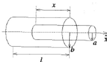
Les bornes de la bobine extérieure sont reliées à un générateur basse fréquence délivrant un courant  $i_b(t) = I_0 \cos \omega t$ .
