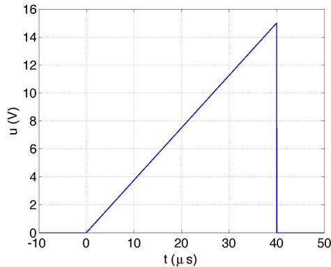
et la tension  $u(M,t)$  atteint la valeur 7,5 V au point  $M$  plus loin sur la ligne, à une distance de 15 km de  $S$ , à la date  $t_1 = 70 \mu s$ .
