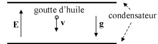
Des gouttelettes d'huile sont pulvérisées dans un condensateur à l'intérieur duquel le champ électrique  $\vec{E}$  est constant. Une gouttelette se déplace par effet de la gravité, du champ et de la friction visqueuse. On supposera que la force de frottement est donnée par la formule :  $F_f = -6\pi\eta r v$ , où  $\eta = 1,8 \cdot 10^{-5} \text{ Pa}\cdot\text{s}$  est la viscosité de l'air et  $r$  le rayon de la gouttelette. On néglige la poussée d'Archimède.
