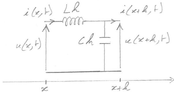
d'inductance  $Lh$  et de capacité  $Ch$ . Les tension et intensité sont  $u(x,t)$  et  $i(x,t)$  en entrée du circuit et  $u(x+h,t)$  et  $i(x+h,t)$
