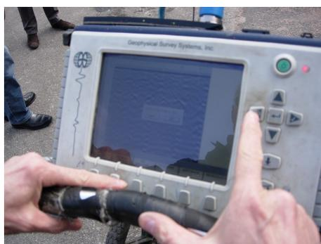
Figure 5.16 – L'interface homme machine du géoradar
