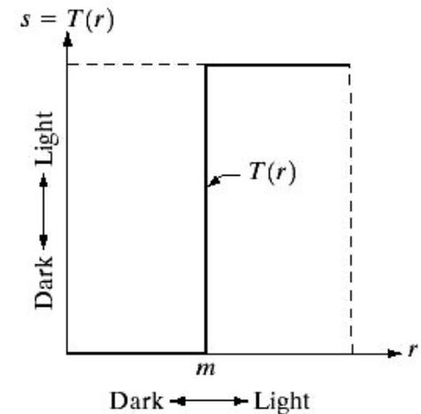
Par exemple, (b)  $T$  peut réduire (*resp.* augmenter) les NdG en deçà (*resp.* au delà) d'une valeur typique  $m$ . Dans le cas limite (c), la transformation correspond à un « seuillage » qui conduit à une image à deux niveaux, c.à.d. binaire.
