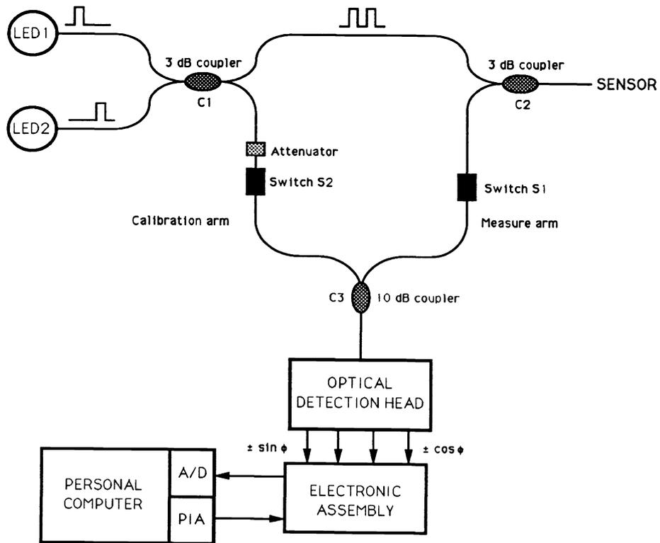
Fig. 3. The ACCORD<sup>®</sup> Module : schematic description
