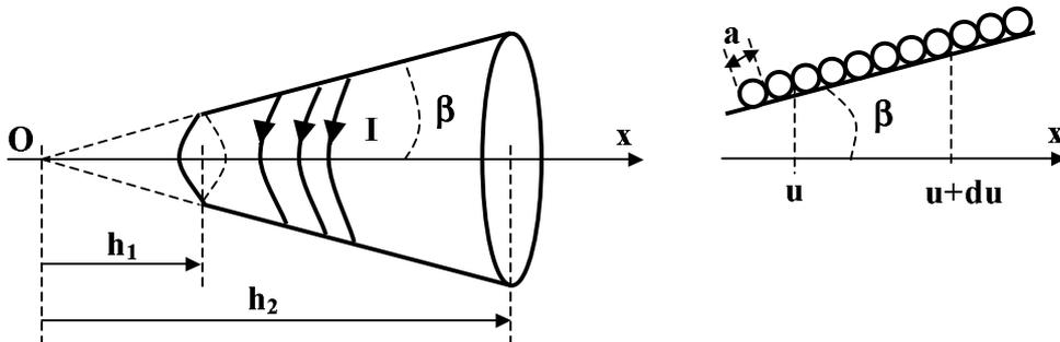
FIG. 2 – à gauche le cône, à droite une représentation en coupe des spires déposées entre les abscisses  $u$  et  $u + du$  (le symétrique par rapport à l'axe  $(Ox)$  n'est pas représenté).
