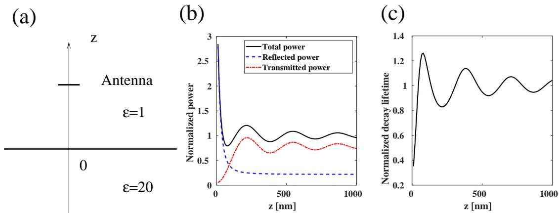
**Figure 5.3 :** (a) Configuration : antenne dans le vide au dessus d'une interface de permittivité  $\epsilon = 20$ . (b) Puissance rayonnée en fonction de la distance de l'antenne à l'interface. (c) Durée de vie d'un atome fluoresceent en fonction de la distance de celui-ci à l'interface.
