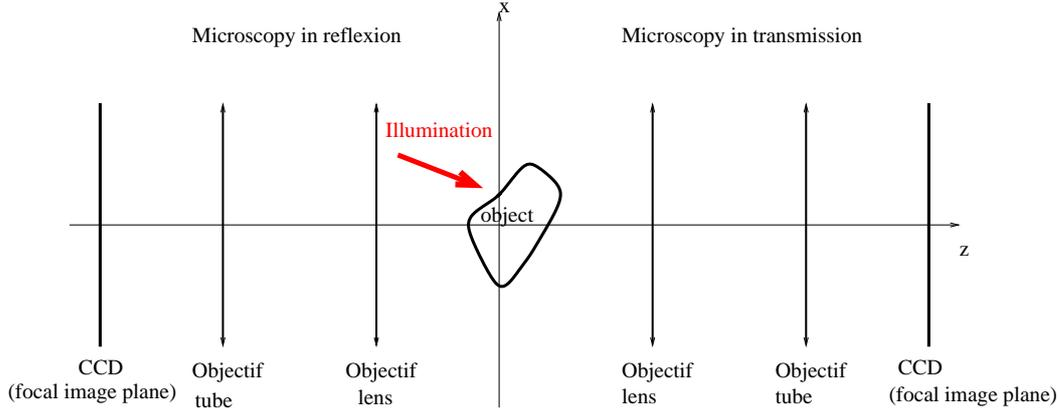
**Figure 8.1 :** Schéma simplifié du microscope. Le foyer objet des lentilles objectifs sont à l'origine du repère par défaut, mais ils peuvent être changés dans le code. L'axe des lentille est confondu avec l'axe  $z$  et l'observation se fait sur la CCD placée au foyer image des lentilles de tube.
