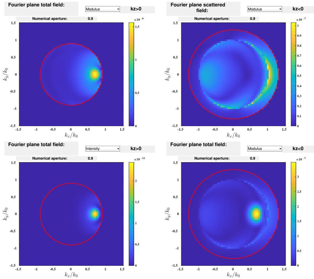
**Figure 11.12 :** *Module du champ de Fourier transmis (gauche) et réfléchis (droite) pour un microscope holographique. Champ diffracté seul (dessus) avec le champ incident (dessous).*
