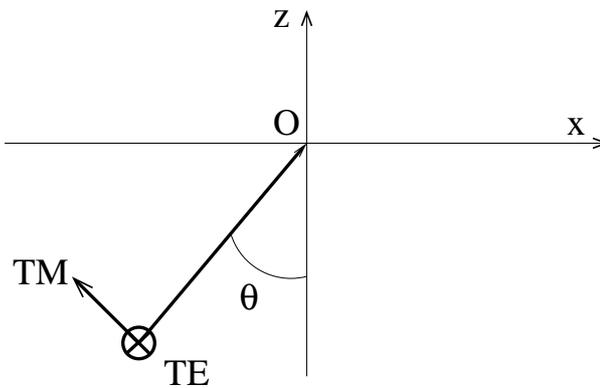
Figure 5.2 : Définition de la polarisation du faisceau.
