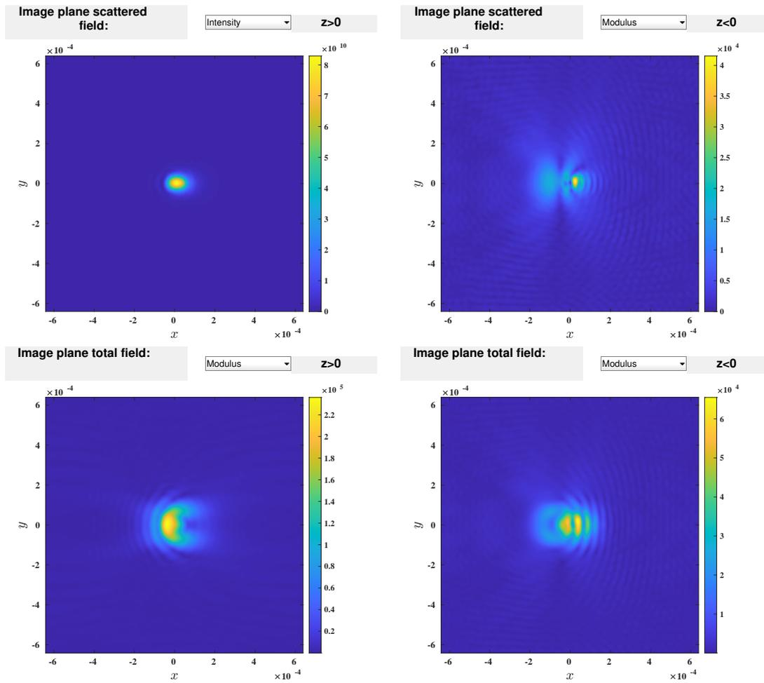
**Figure 11.13 :** Module du champ image transmis (gauche) et réfléchis (droite) pour un microscope holographique. Champ diffracté seul (dessus) avec le champ incident (dessous).
