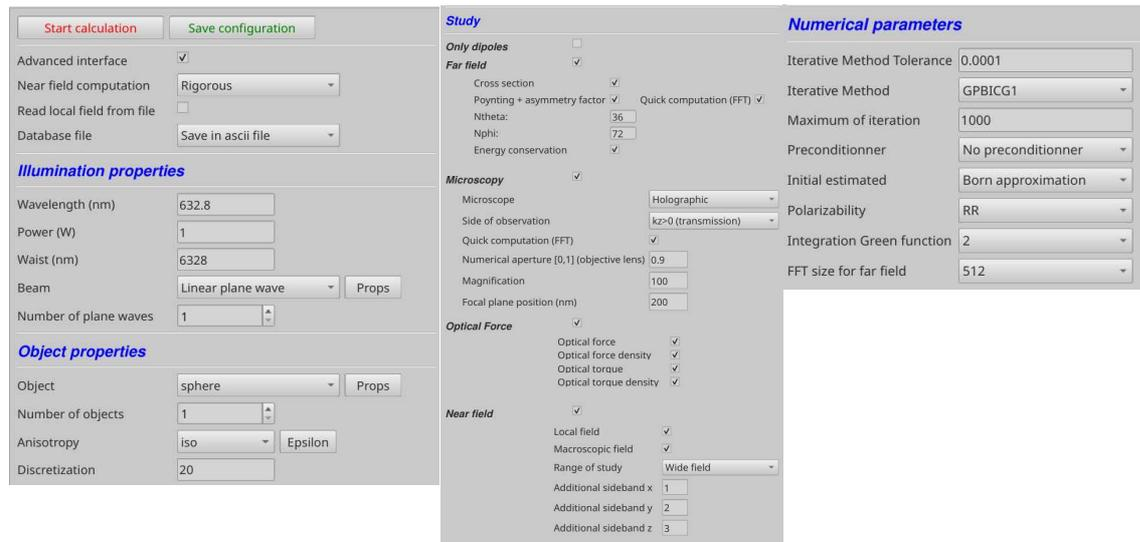
**Figure 10.1 :** Test1 : configuration choisie. La permittivité relative est de 1.5 et la sphère d'un de rayon 200 nm.
