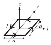
Considérons un circuit électrique en forme de carré, de côté a, situé dans le plan xOy. Un courant constant I circule dans ce circuit.
