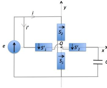
identique au système  $[S]$  est associé à ce premier système. Dans ce circuit, les deux solénoïdes  $S_1$  et  $S_2$  (constituant le système  $[S]$ ) sont d'axe  $(Oy)$  et les deux solénoïdes  $S'_1$  et  $S'_2$  (constituant le système  $[S']$ ) sont d'axe  $(Ox)$ .
