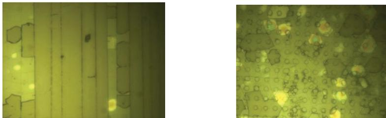
Fig. 2: Etat de la surface d'un échantillon LN vierge et un échantillon PPLN 2D après implantation suivi d'un recuit.
