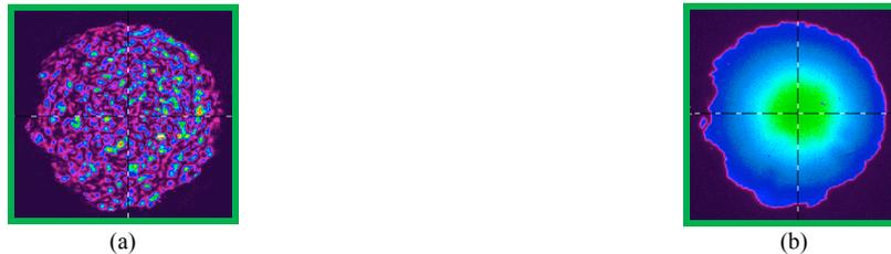
Fig. 3: Mesure de la distribution d'intensité observée en champ proche à l'extrémité du guide ( $d = 100 \mu\text{m}$ ). (a) excitation avec une source de lumière blanche, (b) excitation par le plasma maintenu au sein du guide à cœur creux.
