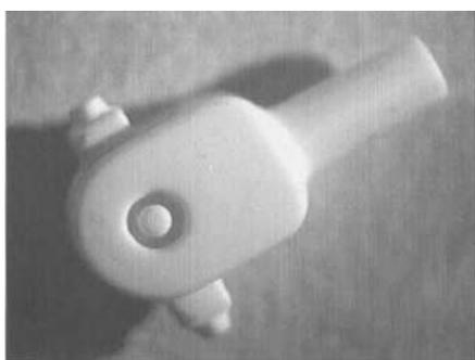
**Figure 12 – Élément de microcardan (matériau A, longueur 3,5 mm)**
