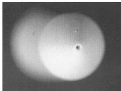
**a) buse** (diamètre de sortie : 120  $\mu\text{m}$ )
